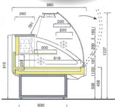
**Konditorei Kühltheke CAKE, für Konditoreiprodukte, +4° C / +6° C, gebogene Frontscheibe, Unterbaukühlung mit Schubladen, statische Kühlung, 3 Zwischenglassetagen und Granitarbeitsplatte, 230V / 50Hz**
