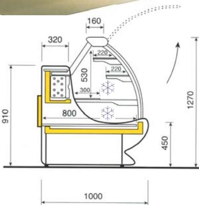
**Konditorei Kühltheke SYMPHONY, für Konditoreiprodukte, +4° C / +6° C, gebogene Hebefrontscheibe, Unterbaukühlung mit Schubladen, statische Kühlung, 3 Zwischenglassetagen und Granitarbeitsplatte, 230V / 50Hz**
