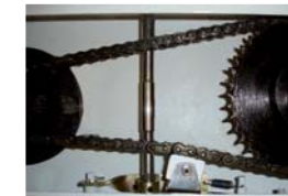
automatischer Kettenspanner zur Schonung der Kette und der Zahnräder
