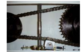
automatischer Kettenspanner zur Schonung der Kette und der Zahnräder
